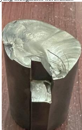
Gambar 2. Pengamatan visual terhadap Poros HPU yang gagal.
