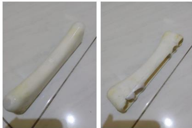
Gambar 9. Hasil bantalan ketiak tongkat kruk variasi temperatur leleh 200°C dengan tekanan injeksi 100 Bar
