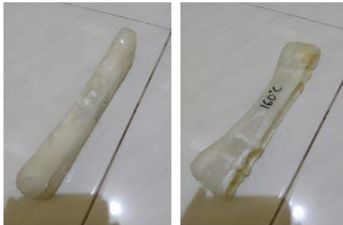
Gambar 7. Hasil bantalan ketiak tongkat kruk variasi temperatur leleh 160°C dengan tekanan injeksi 100 Bar
