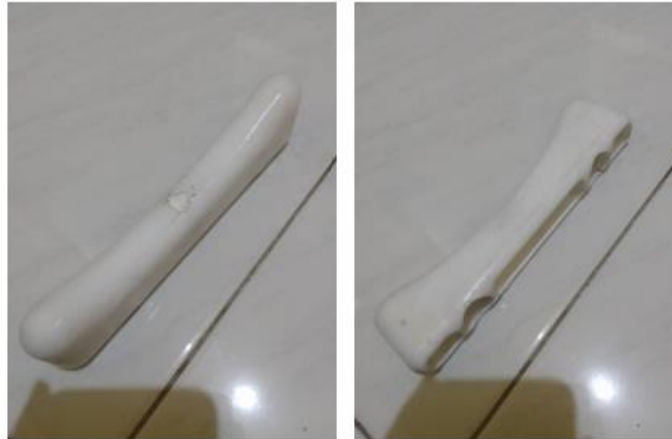
Gambar 10. Hasil bantalan ketiak tongkat kruk variasi temperatur leleh 200°C dengan tekanan injeksi 150 Bar
