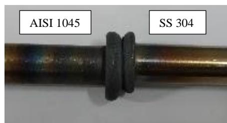
**Gambar 8.** FW Udara Waktu Tempa 6 detik
