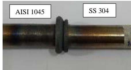
**Gambar 7.** FW Udara Waktu Tempa 4 detik
