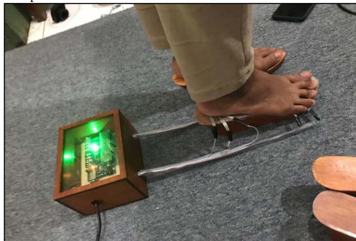
Gambar 20 Subjek berdiri pada pelat pengukur gaya
