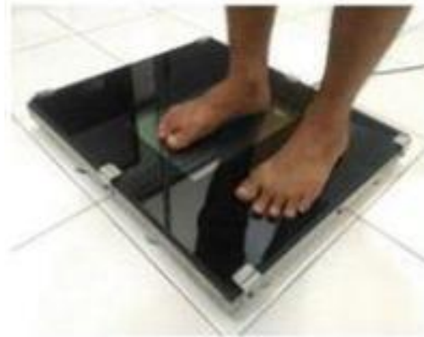
Gambar 2 Pengukuran ukuran sepatu menggunakan scan 2D
