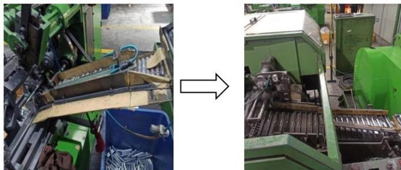
**Gambar 2.** Perbedaan sistem *feeder* pada mesin *trimming*
