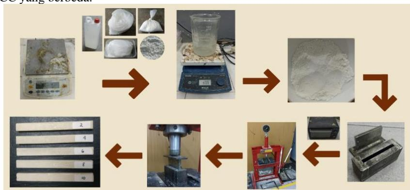
Gambar 2. *Set-up* pembentukan komposit PVC
