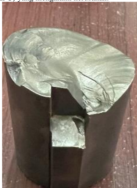
Gambar 2. Pengamatan visual terhadap Poros HPU yang gagal.
