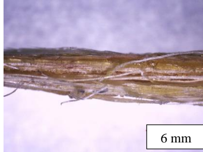
Gambar 15. Delaminasi pada komposit dengan fraksi massa 15 wt%
