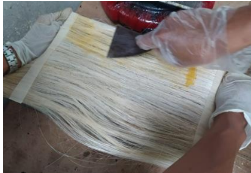
Gambar 4. Proses pengolesan matriks
