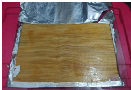
Gambar 8. Hasil proses pengepresan spesimen
