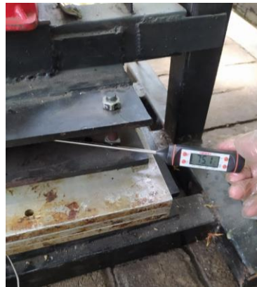
Gambar 7. Suhu saat proses pengepresan
