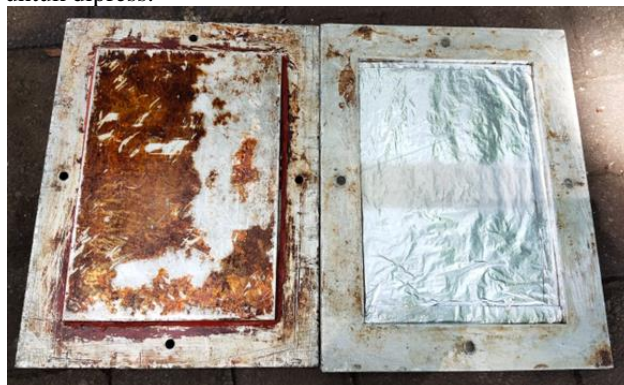
Gambar 6. Komposit yang dibungkus aluminium foil dan siap dipress.
