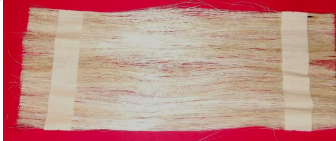
Gambar 1. Penyusunan serat rami
