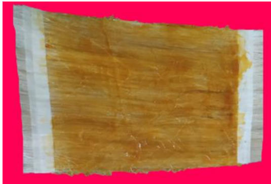
Gambar 5. Hasil pembuatan komposit metode hand lay-up
