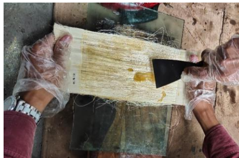
Gambar 4. Proses pengolesan matriks
