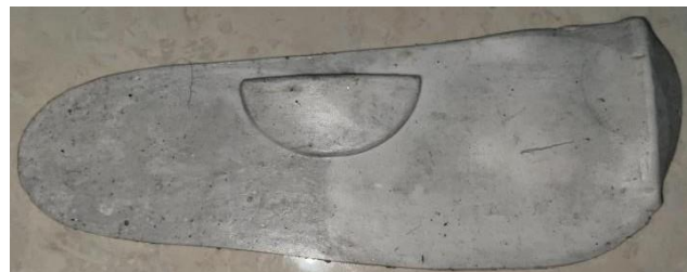
Gambar 9. Hasil cetakan insol sepatu dengan suhu 100^{\circ}\text{C} dan tekanan 100 bar dengan menggunakan RTV 497 talc 20%
