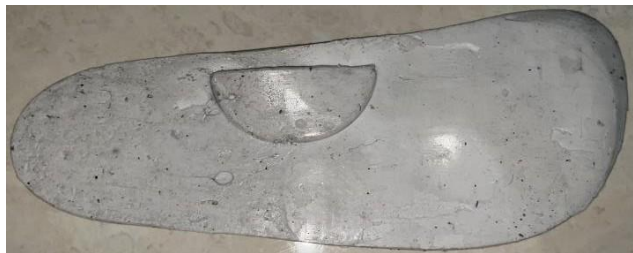
Gambar 8. Hasil cetakan insol sepatu dengan suhu 75^{\circ}\text{C} dan tekanan 150 bar dengan menggunakan RTV 497 talc 20%
