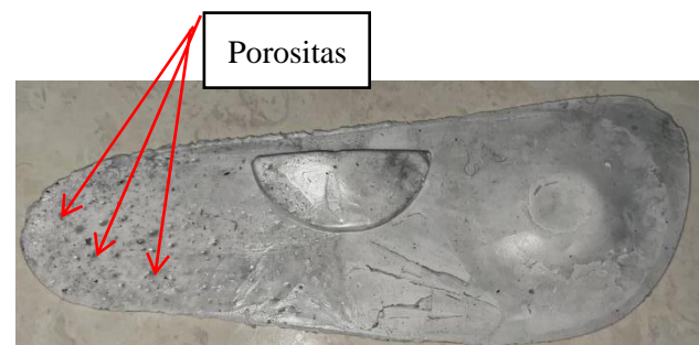
Gambar 10. Hasil cetakan insol sepatu dengan suhu 100^{\circ}\text{C} dan tekanan 150 bar dengan menggunakan RTV 497 talc 20%
