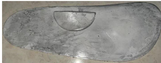
Gambar 7. Hasil cetakan insol sepatu dengan suhu 75^{\circ}\text{C} dan tekanan 100 bar dengan menggunakan RTV 497 talc 20%
