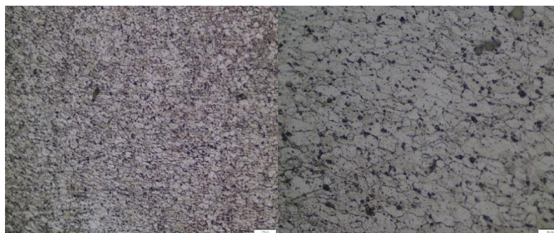
Gambar 4. Hasil Uji Metalografi Perbesaran 200x, 500x Spesimen Tidak Mengalami Kegagalan
