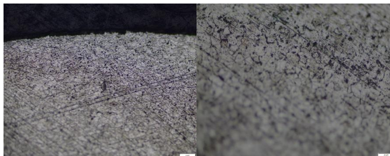
Gambar 3. Hasil Uji Metalografi Perbesaran 200x, 500x Spesimen Mengalami Kegagalan
