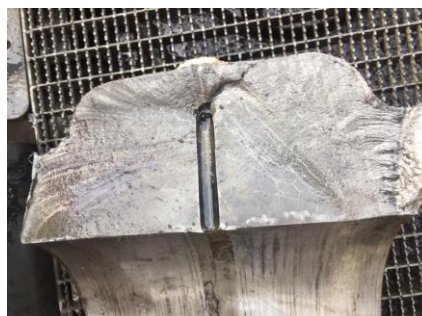
Gambar 2. Pengamatan visual terhadap boom yang gagal.
