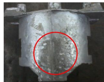
Gambar 15. Permukaan kasar pada temperatur cetakan 320°C
