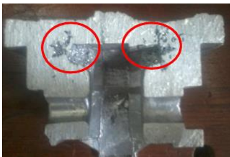
Gambar 10. Shrinkage pada temperatur cetakan 250°C
