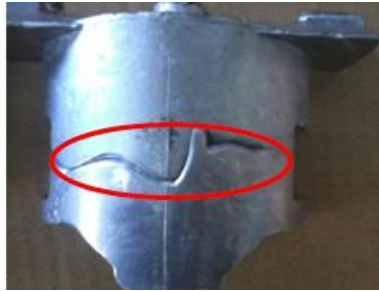
Gambar 9. Cacat pertemuan dingin pada temperatur cetakan 250°C
