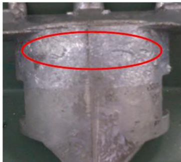
Gambar 16. Permukaan kasar pada temperatur cetakan 350°C
