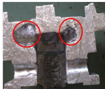
Gambar 12. Shrinkage pada temperatur cetakan 350°C
