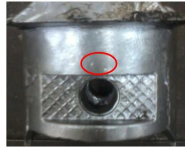
Gambar 17. Permukaan kasar pada temperatur cetakan 400°C
