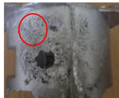
Gambar 18. Porositas pada temperatur cetakan 250°C
