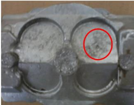
Gambar 19. Porositas pada temperatur cetakan 320°C
