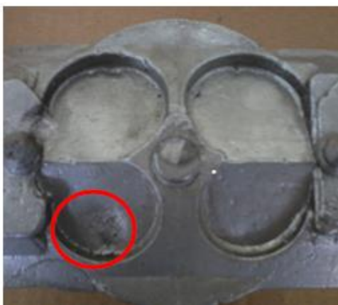
Gambar 20. Porositas pada temperatur cetakan 350°C
