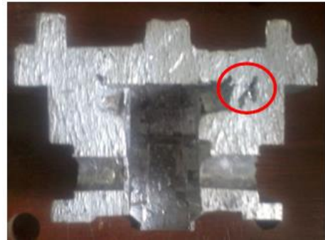
Gambar 11. Shrinkage pada temperatur cetakan 320°C
