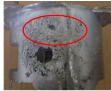
Gambar 14. Permukaan kasar pada temperatur cetakan 250°C
