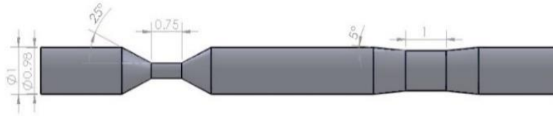
Gambar 1. Fiber Optik PMMA dengan panjang tapered 0.75 mm dan sudut 25°
