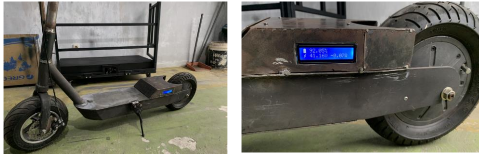
Gambar 4. Hasil pemasangan casing pada otoped
