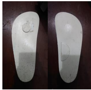
Gambar 11. Hasil insole sepatu variasi suhu 75° dengan komposisi silicone rubber 80% dan talc 20%
