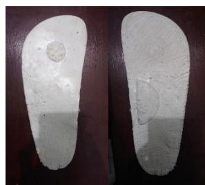
Gambar 10. Hasil insole sepatu variasi suhu 100° dengan komposisi silicone rubber 80% dan talca 20%
