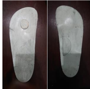
Gambar 12. Hasil insole sepatu variasi suhu 75° dengan komposisi silicone rubber 80% dan talc 20%
