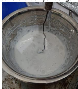
Gambar 9. Hasil Pencampuran Silicone Rubber dan Hardener
