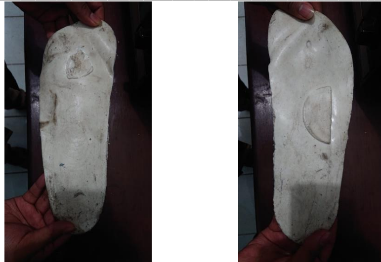
Gambar 9. Variasi suhu 75°C dengan tekanan 150 bar dan komposisi talc 10%
