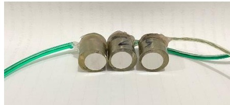
Gambar 3. Hasil setelah Grinding dan Polishing
