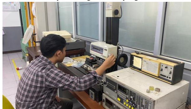
Gambar 4. Proses pengujian kekasaran permukaan
