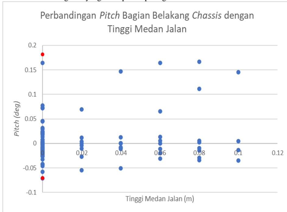
**Gambar 24.** Grafik perbandingan sudut *pitch* bagian belakang *chassis* dengan ketinggian permukaan jalan
