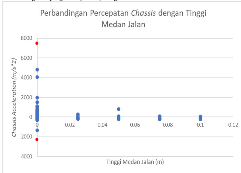
**Gambar 14.** Grafik perbandingan percepatan *chassis* dengan ketinggian permukaan jalan
