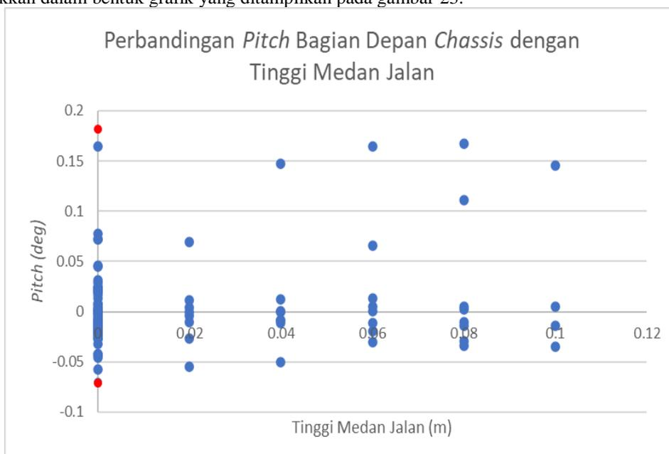
**Gambar 23.** Grafik perbandingan sudut *pitch* bagian depan *chassis* dengan ketinggian permukaan jalan
