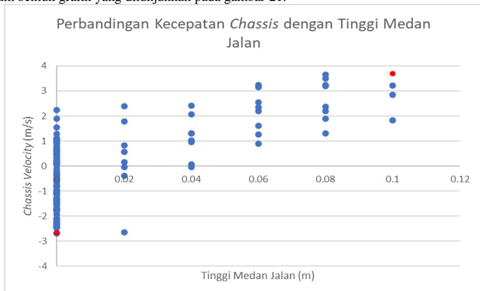
**Gambar 21.** Grafik perbandingan kecepatan *chassis* dengan ketinggian permukaan jalan
