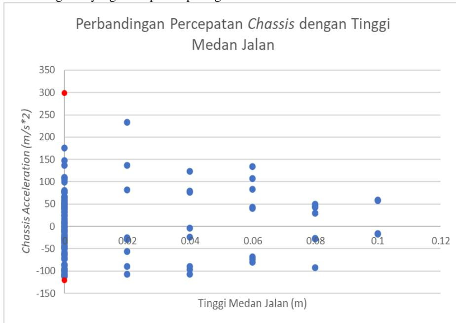
**Gambar 22.** Grafik perbandingan percepatan *chassis* dengan ketinggian permukaan jalan
