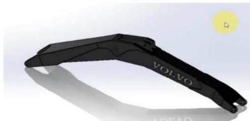
Gambar 2. Hasil Desain CAD Boom Excavator.
