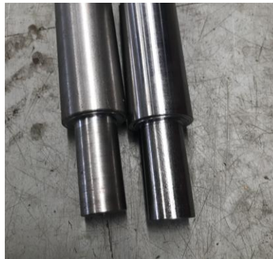
Gambar 18. Hasil manufaktur rear shaft .
