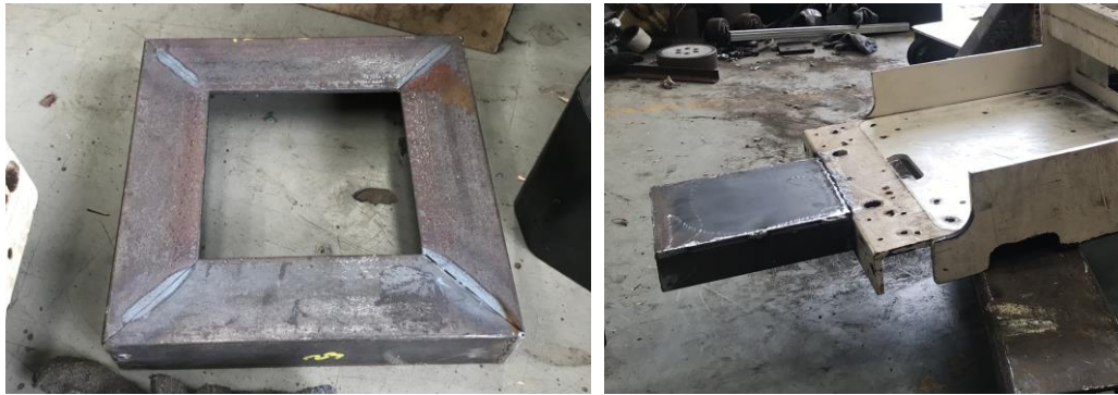
Gambar 17. Rangka extension untuk support sistem kemudi.
