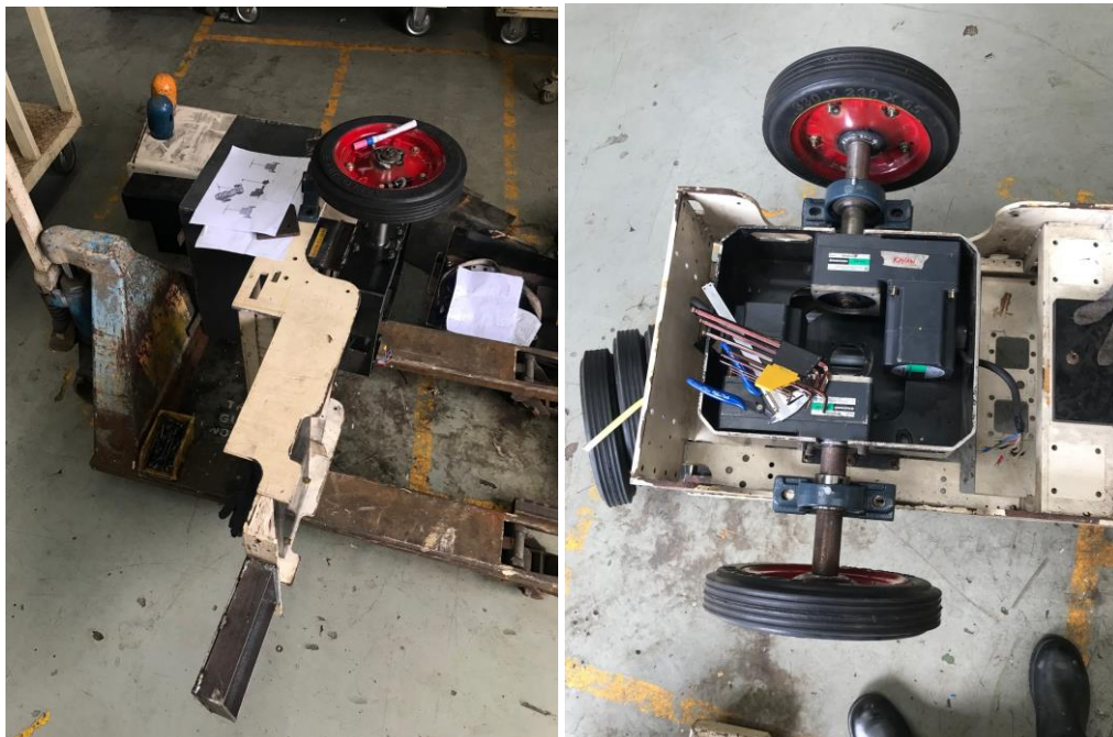
Gambar 21. Instalasi sistem penggerak pada rangka utama.
