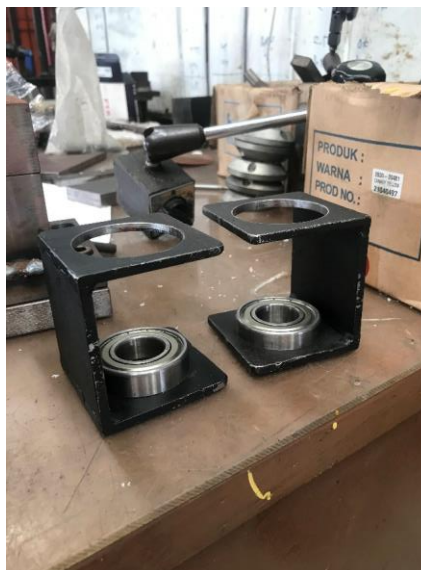
Gambar 27. Komponen C arm dan fitting serta instalasi bearing .
