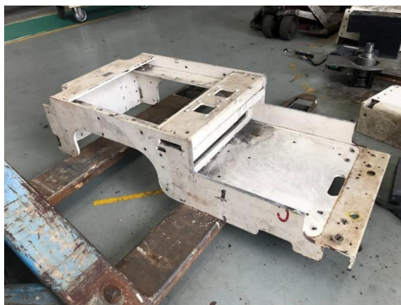
Gambar 16. Rangka utama yang telah dimodifikasi dari rangka AGV.
