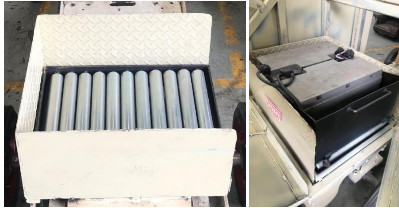
Gambar 22. Instalasi slot baterai pada electric towing tractor berikut dengan baterainya.
