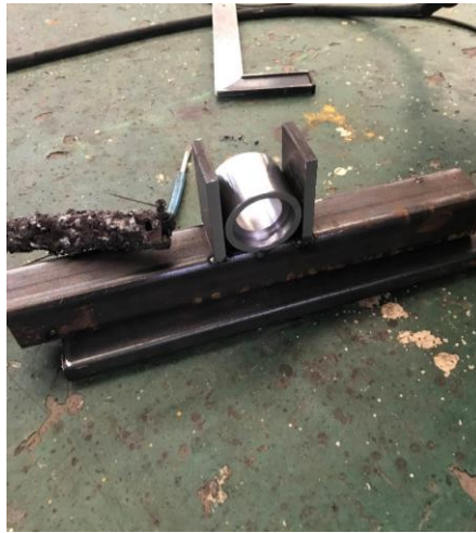
Gambar 28. Komponen assembly steering shaft bushing dengan rangka sistem kemudi.
