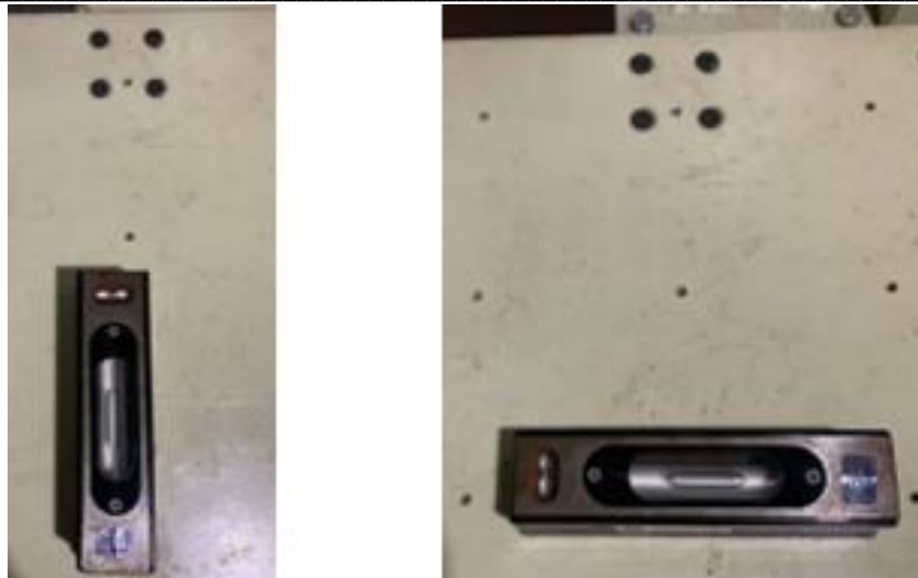
Gambar 5. Pengujian Kedataran Meja Mesin.
