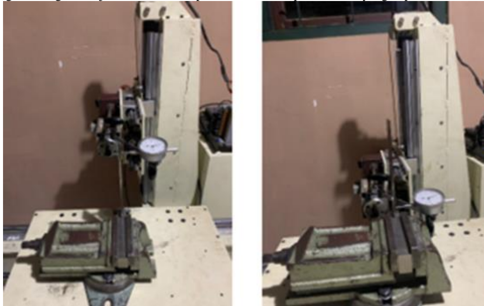
Gambar 7. Pengujian Kesikuan Antara Meja Kerja Dan Gerakan Pahat.
