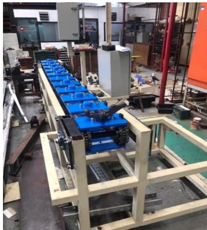
**Gambar 9.** *Chain Conveyor* yang Sudah di *Assembly*
