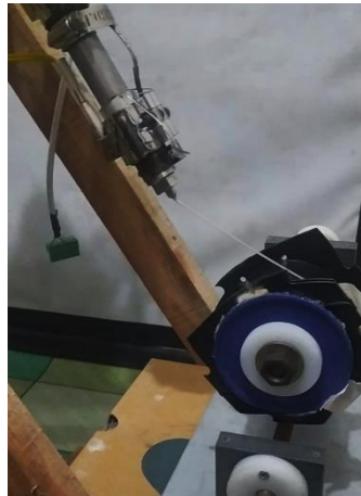
Gambar 1. Proses ekstrusi filamen
