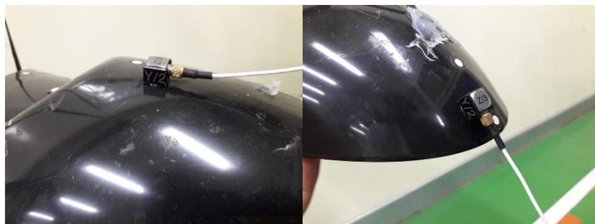
Gambar 3. Penempatan *Accelerometer*
