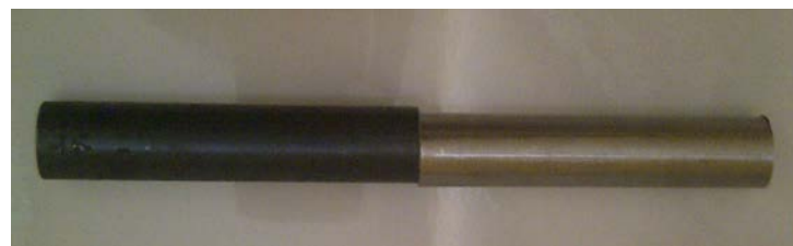
Gambar 4. Bahan uji las gesek (a) Baja ST 60 dan (b) AISI 201
