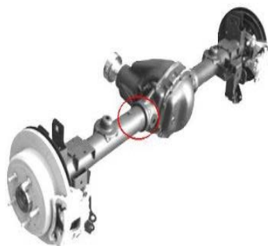
Gambar 2. Pengelasan gesek pada gardan mobil [3].
