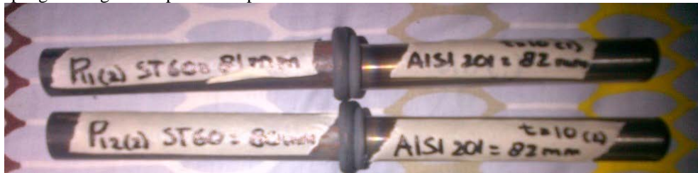
Gambar 6. Hasil sambungan las gesek baja ST 60 dengan AISI 201
