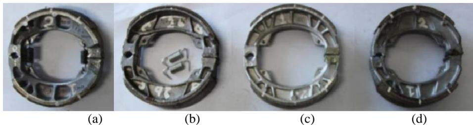
Gambar 2. Kampas rem tromol (a) AHM, (b) merk OES, (c) merk Binapart, (d) merk Indopart.
