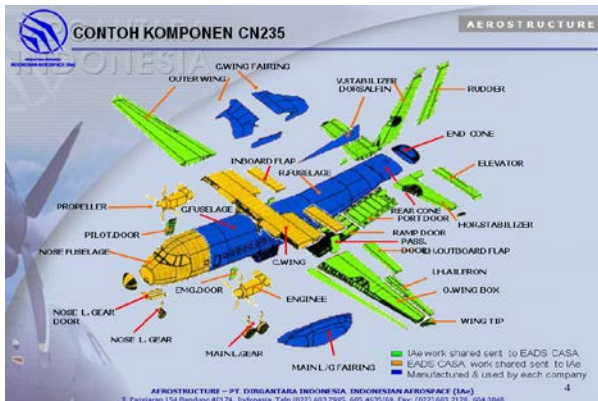
Gambar 7 Komponen pesawat CN-235 [3]
