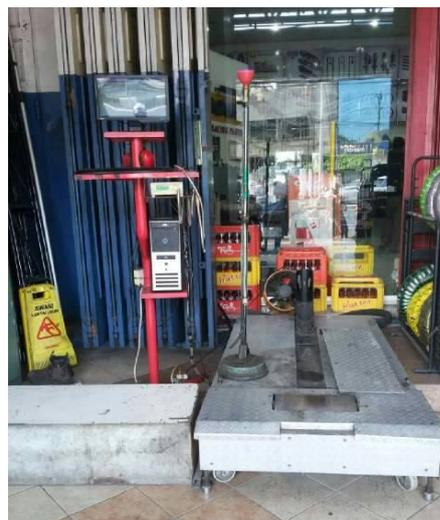
**Gambar 5.** Dinamometer sistem inersia
