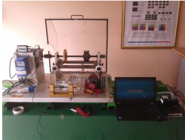
Gambar 2 Instalasi alat Machinery Fault Simulator untuk uji rotor unbalance
