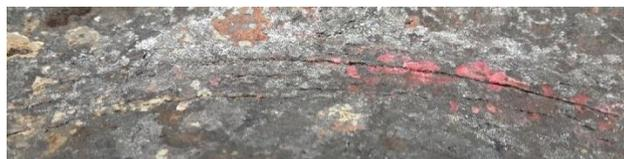
**Gambar 3.** Pola retakan pada permukaan dalam pipa.
