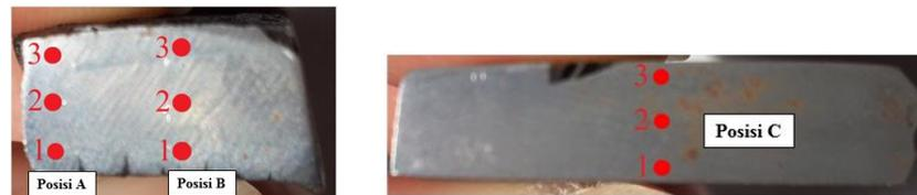
**Gambar 7.** Pembagian posisi dan titik pengujian kekerasan.
