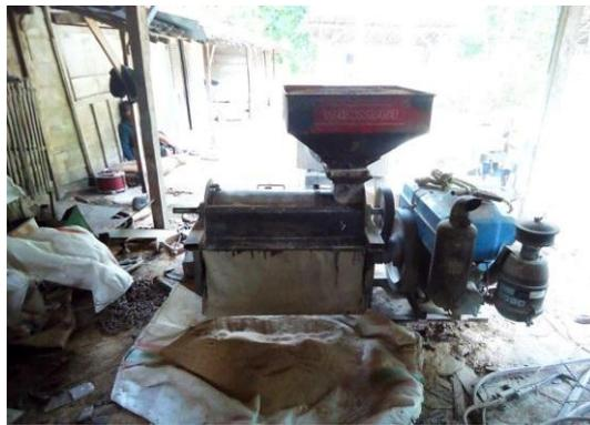
**Gambar 3.** Mesin Penggiling sekam.
