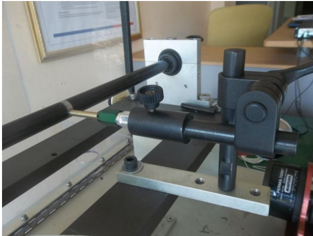
Gambar 2. Pemasangan Mechanical Rub Kit pada MFS
