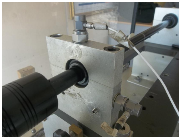
Gambar 4. Pemasangan sensor arah radial vertikal dan horizontal pada rumah bearing
