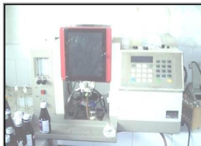
Gambar 3. Mesin Uji AAS.
