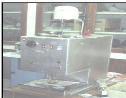
Gambar 2. Viskometer Saybolt.
