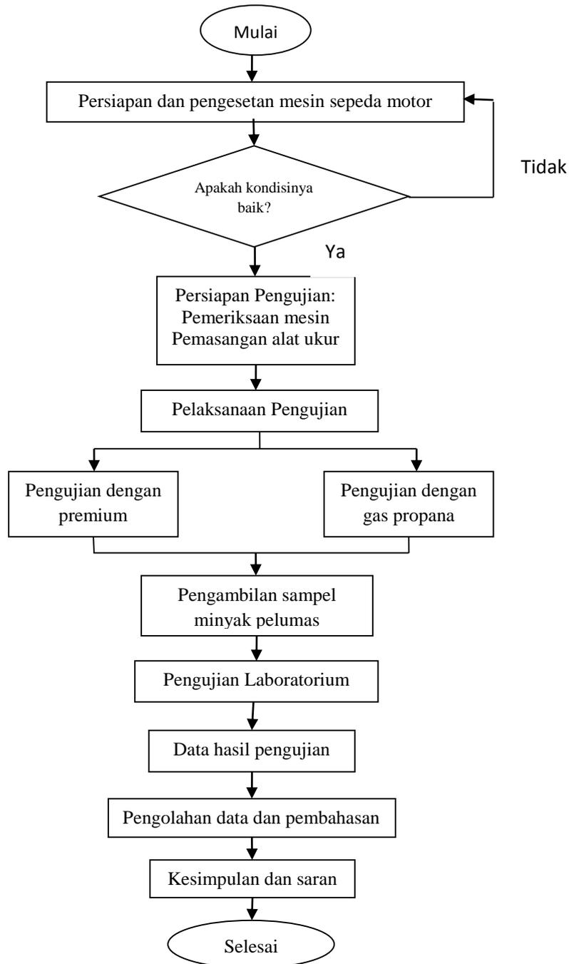
**Gambar 6.** Diagram alir metodologi pengujian.
