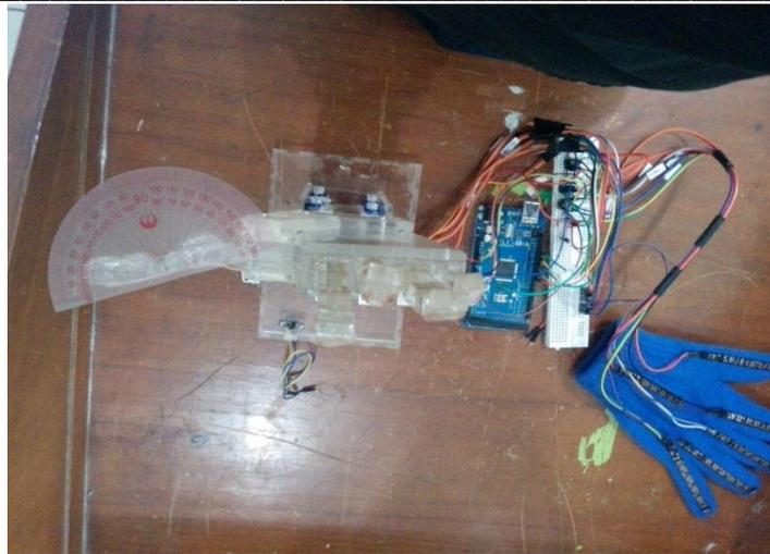
**Gambar 5.** Pengujian Sudut Antara Gerak Motor Servo dengan Tiap Join Jari Tangan Robot.
