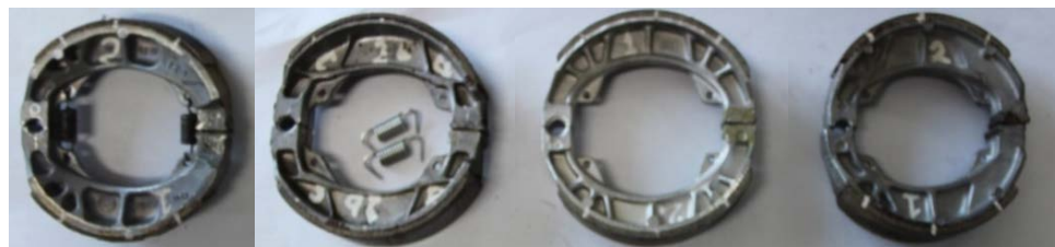
Gambar 2. Kampas rem tromol (a) AHM, (b) merk OES, (c) merk Binapart, (d) merk Indopart.
