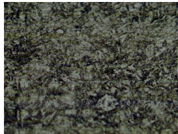
Gambar 7. Hasil uji mikro pada baja paduan 30CrMo.
