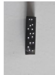
**Gambar 5.** Spesimen uji kekerasan.
