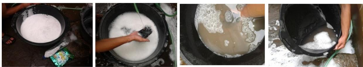
**Gambar 6.** Pencucian pasir besi dengan detergen
