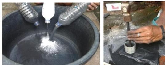
**Gambar 9.** Proses pencampuran dan kompaksi
