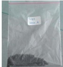
**Gambar 7.** Sampel *raw material* pasir besi untuk pengujian AAS
