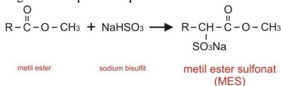
Dari reaksi tersebut, dimana metil ester bereaksi dengan sodium bisulfit membentuk MES. Gugus sulfonat dari sodium bisulfit bergabung dengan gugus hidrokarbon dari metil ester sehingga terbentuk senyawa metil ester sulfonat (MES).
