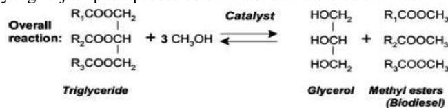
Mekanisme reaksi transesterifikasi dibagi menjadi tiga tahap. Tahap pertama adalah penyerangan ikatan karbonil pada trigliserida oleh anion dari alkohol dan membentuk zat antara tetrahedral. Pada tahap kedua, zat antara tetrahedral bereaksi dengan alkohol dan terbentuk anion dari alkohol. Pada tahap akhir, zat antara tetrahedral mengalami transfer proton sehingga terbentuk ester dan gliserol. (Siti Miskah, *Jurnal Rekayasa sriwijaya* 2008)
