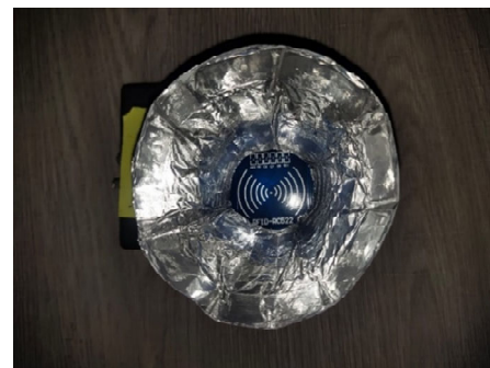
Gambar 8. Sensor dengan tambahan kertas aluminium
