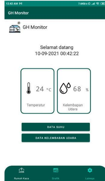
Gambar 11 Tampilan Data Terakhir Suhu dan Kelembaban Udara Kondisi OFF
