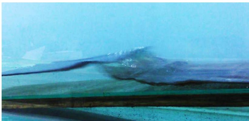
Gambar 5. Gelombang Pecah pada Daerah Peredam Gelombang
