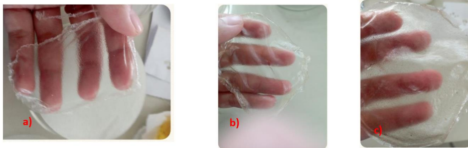
Gambar 6. Hasil sintesa bioplastik dengan penambahan selulosa; a) tanpa penambahan selulosa; b) penambahan selulosa 0,2%; c) penambahan selulosa 0,4%
