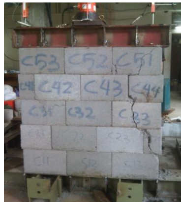
Gambar 8. Tampak Depan Kerusakan Dinding BTPTP
