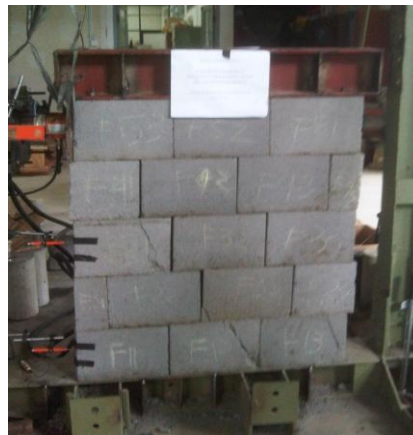
Gambar 12. Tampak Depan Kerusakan Dinding BTPTP
