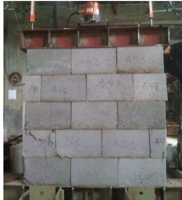
Gambar 6. Tampak Depan Kerusakan Dinding BTPTP
