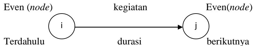
Gambar 1. Simbol yang Digunakan Jaringan Kerja
