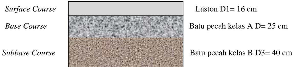
**Gambar 2.** Tebal lapis perkerasan lentur
