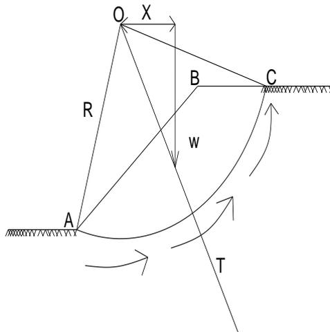
Gambar 2.1. Mekanika pada sebuah bidang longsoran rotasi
