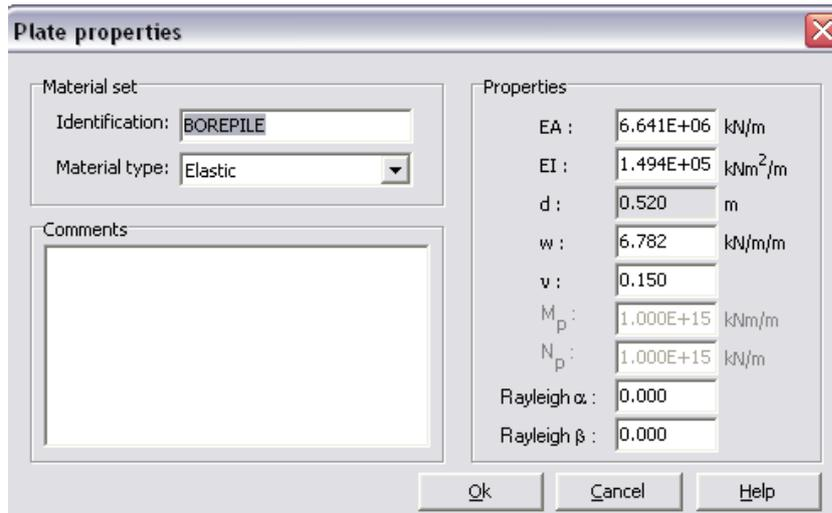
Gambar 2.12. Properties untuk Bored Pile WF-80
